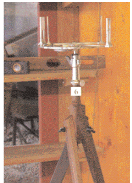
Photo d'un dessin de “levé à la planchette” , trouvé sur une paroi des galeries de servitude de l'IDC dans le 13 e arrondissement. Cet appareil était utilisé pour mesurer les angles, le plan étant dessiné lors du levé, à la main, sur une feuille de papier posée sur la planchette.
